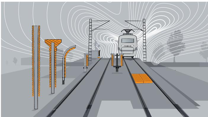
Lärmschutzwand, LSW mit Aufsatzelement, Kleiner Bogen, niedrige Lärmschutz- und Mittelwand, hochabsorbierende Bahnsteigkanten, Gleisabsorber Rieton
